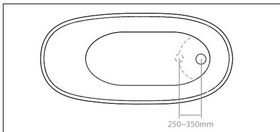
3. Suspenda a sua banheira no local onde ela será posicionada e conecte o sifão na saída de água do piso;
