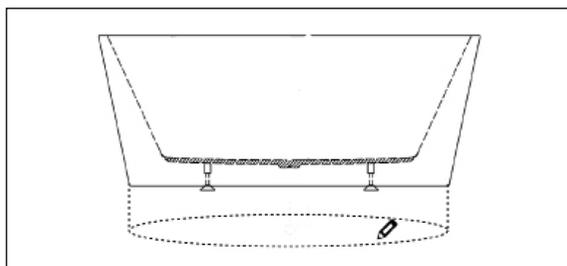
2. Faça a saída de escoamento no piso que seja compatível com o flexível de 35mm que acompanha a banheira. **O furo deve ser feito a uma distância de 250~350mm do local demarcado da válvula;**
