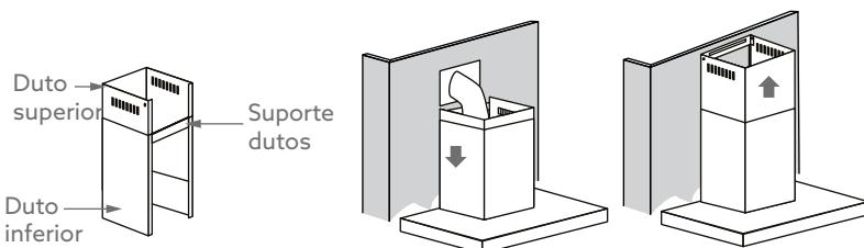
**NOTA:** As duas aberturas de ventilação estão posicionadas no duto/corpo na parte superior, com um diâmetro de 6 mm. Deite o tubo de exaustão para a saída da parede. Fixe o tubo de exaustão com a braçadeira na saída da parede.
